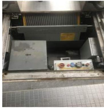
5.1.2 拆下主机飞轮保护罩，用手拧松碟形螺栓(共三颗)，拆下飞轮保护罩。拧下来的碟形螺栓和拆卸的飞轮保护罩，放置在指定位置。；（如图所示）
